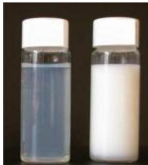
Figura 5: Imagem de uma nanoemulsão (à esquerda) e uma macroemulsão (à direita) com diâmetros de gotas de 35 nm e 1  $\mu$ m, respectivamente (BETTIO, 2011).
